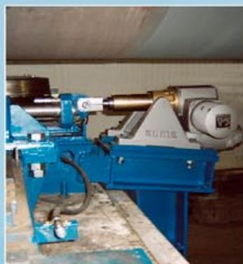
Устройство осевого перемещения корпуса вращающейся печи (электр.)
