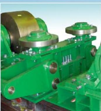
Устройство осевого перемещения корпуса вращающейся печи (гидравл.)
